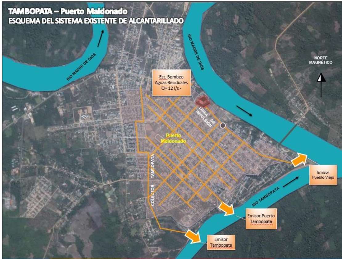
Imagen N° 9: Sistema de Alcantarillado
