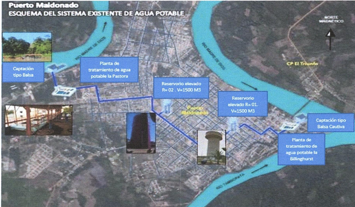
Ilustración 1. Esquema del Sistema de Agua Potable
